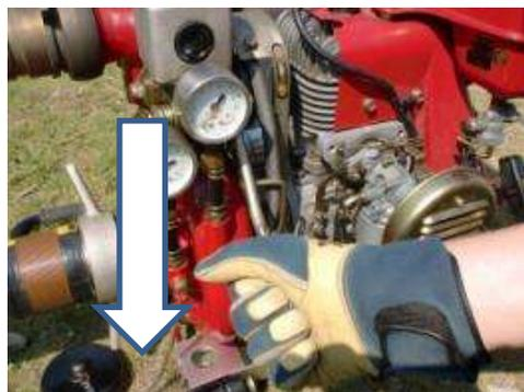
⑧可搬ポンプ下部より水が吐出したら、切り替えコックを「放水」の位置に戻します。
