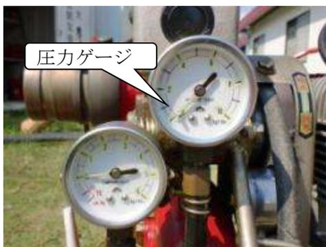
⑩放水したらスロットルレバーを徐々に「高速」に近づけ、圧力ゲージを見ながら水圧を調節する。
