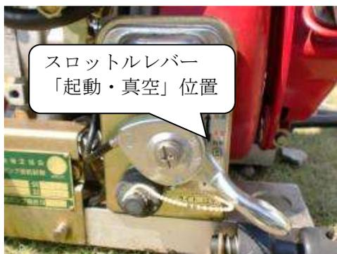
⑥スロットルレバーを「起動・真空」の位置に合せ、エンジンを起動させます。
