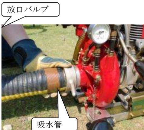
③吸水管を可搬ポンプの吸水口に取り付けます。
