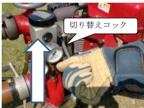
⑦エンジンが起動したら、切り替えコックを「吸水」位置(水平)に引き上げ、真空ポンプを作動させます。
