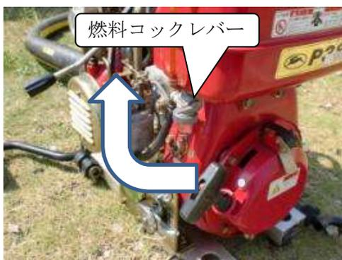
③エンジンが停止したら、燃料コックレバーを「OFF」の位置に合せます。
