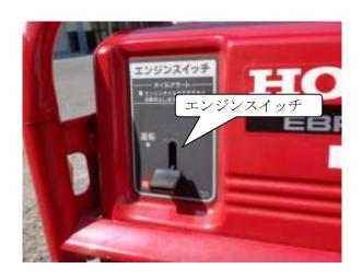
③エンジンスイッチを「停止」に合せると、エンジンが停止します。
