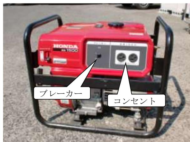
⑥ブレーカー及び使用機器のスイッチが切れていることを確認し、コンセントへ使用機器のプラグを差し込みます。
