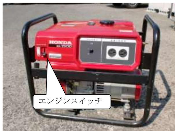
③エンジンスイッチを「停止」に合せると、エンジンが停止します。
