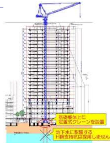
図：クレーン設置のイメージ
