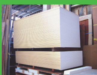
建築資材（石膏ボード）
