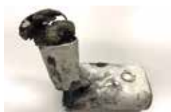
▲発火原因となった加熱式タバコ 【出典：(公財) 日本容器包装リサイクル協会】
