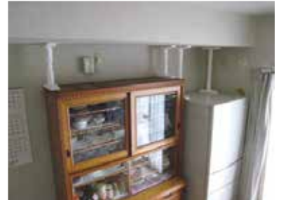
▲転倒防止器具の取り付け
