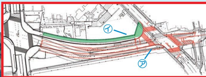
② 県道三島裾野線との交差点の改良工事を行い、右折レーンを設置して、渋滞対策を図ります。そのため、道路の形状を変更します。
