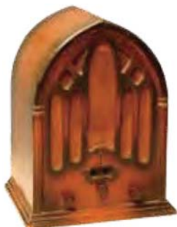
ミゼット型ラジオ 昭和初期 スピーカーと一緒にになりました。
