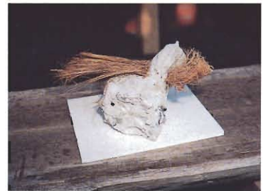
竹筋コンクリート破片 (富士竹類植物園 所蔵)
