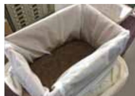
ネットを箱にかぶせてから母材を入れます
