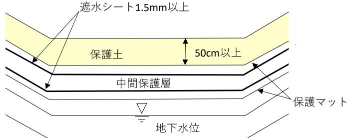
図 6 本処分場における遮水工の基本構造
