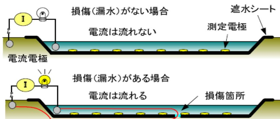
図 7 漏水検知システム原理例
