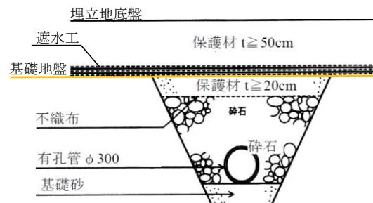
図 5 地下水集排水施設の概念図
