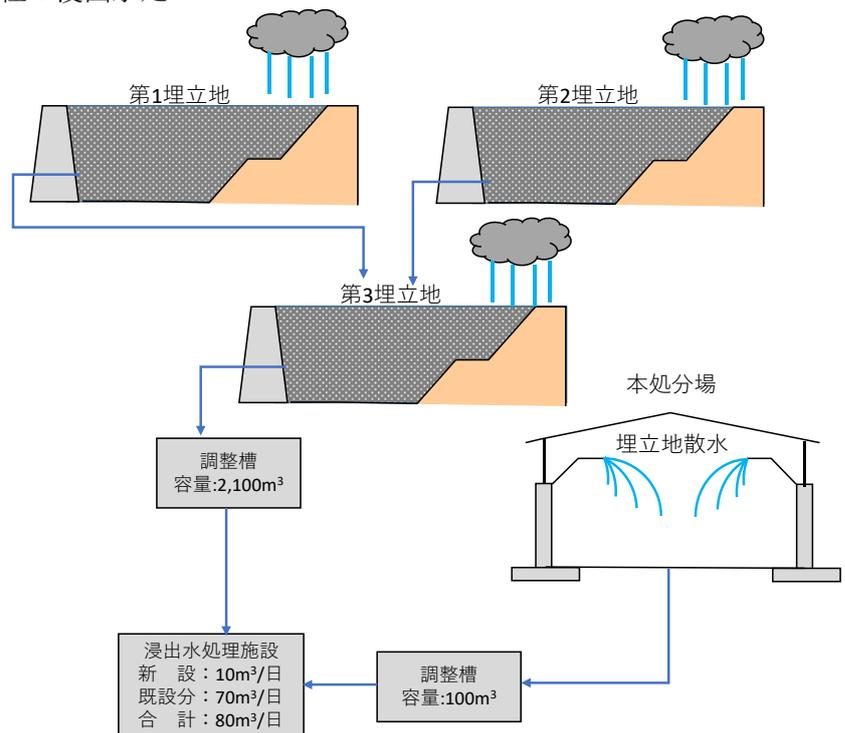
図 11 浸出水処理の概念図
