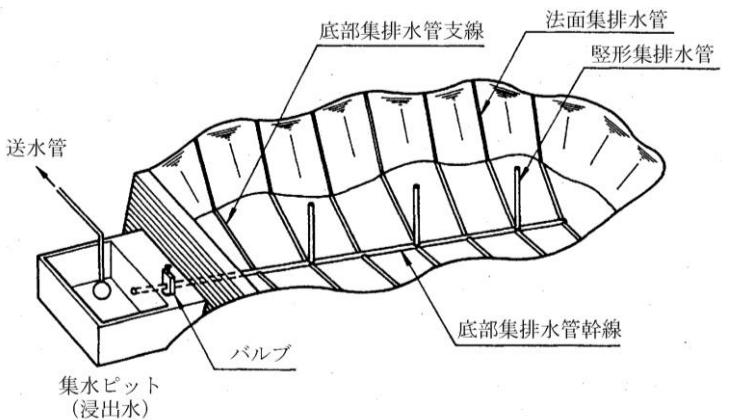
図 9 浸出水集排水設備の概念図
