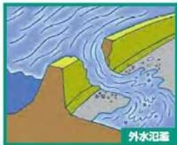
川の水位があがり、堤防を越えたり堤防がきれて、水が流れ出て浸水します。
