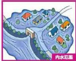
大雨が降り、川の水位が上がると排水路からうまく排水されず浸水します。
