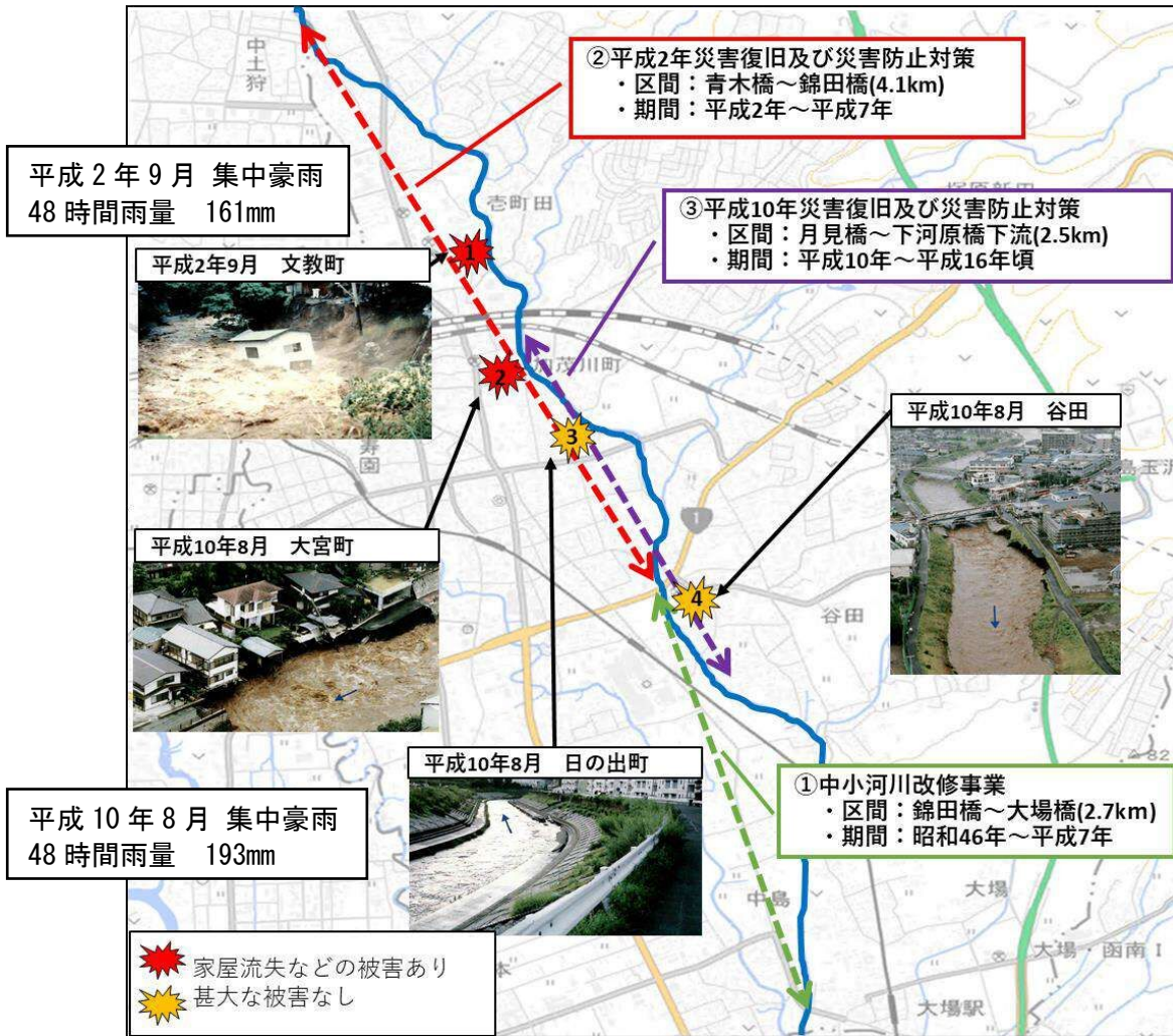
図表 別添 6-5 大場川の護岸侵食等の被害と改修区間図
