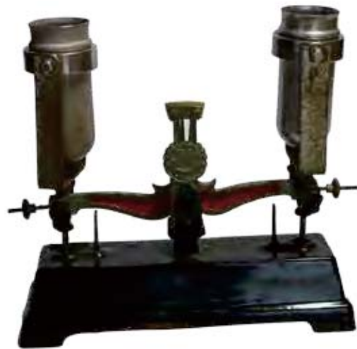
右：液体用の天秤。液体を入れるため変わった皿の形をしている。（福元清一氏所蔵）
