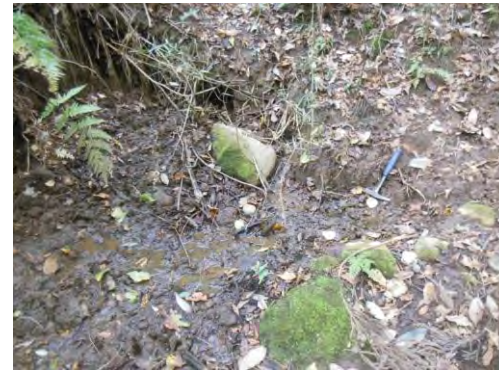
⑦ ⑥露頭の近景で、凝灰質礫岩と凝灰岩の境界 柄部分は凝灰質礫岩で、層中から湧水発生。先端部は凝灰岩。
