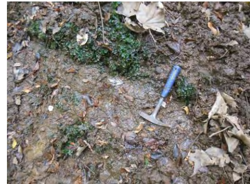
⑦ ⑥露頭の近景で、凝灰質礫岩と凝灰岩の境界 柄部分は凝灰質礫岩で、層中から湧水発生。先端部は凝灰岩。
