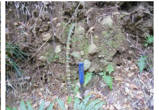
⑮ 凝灰質礫岩の露頭 風化により固結度低下、礫は容易に外れる。
