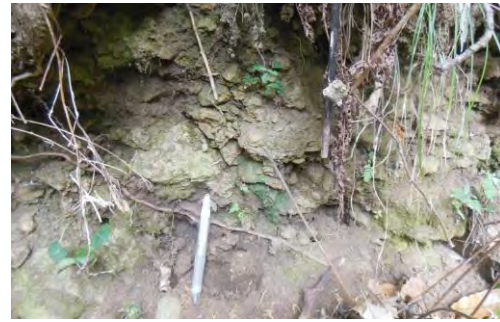
① 山裾部に分布する崖錐堆積物 締まりの悪い礫混じりシルトよりなる。
