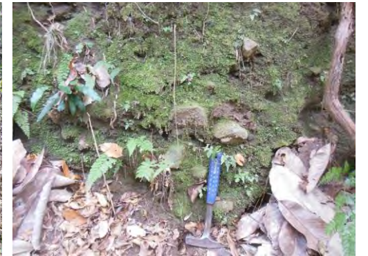
⑩ 自破砕状安山岩の露頭 硬質部が突出しており、凝灰角礫岩の様相を示す。
