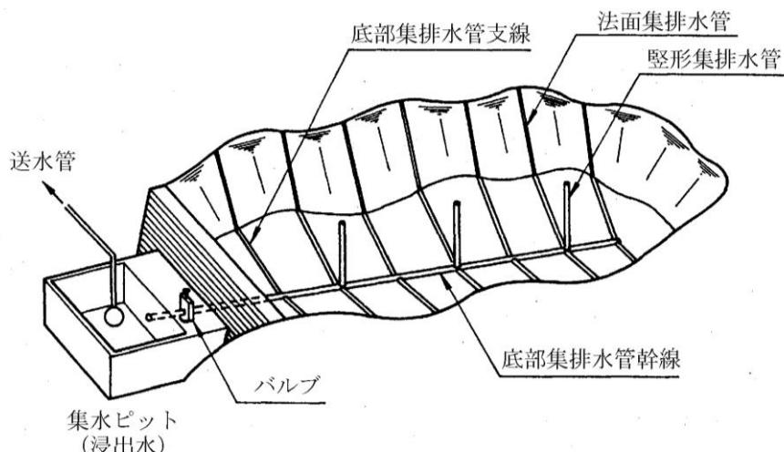
図 3-72 浸出水集排水施設の概念図
