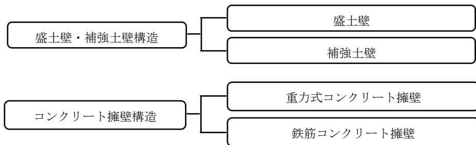
図 3-63 貯留構造物の構造形式（再掲）
