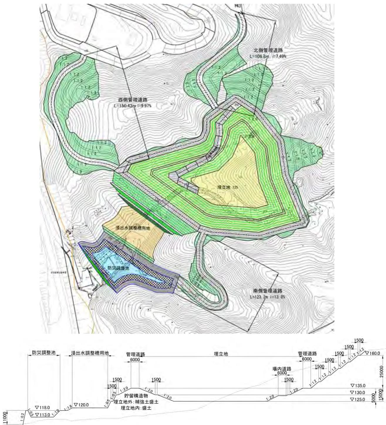
図 3-40 基本計画（案2）平面図（上）、標準断面図（下）
