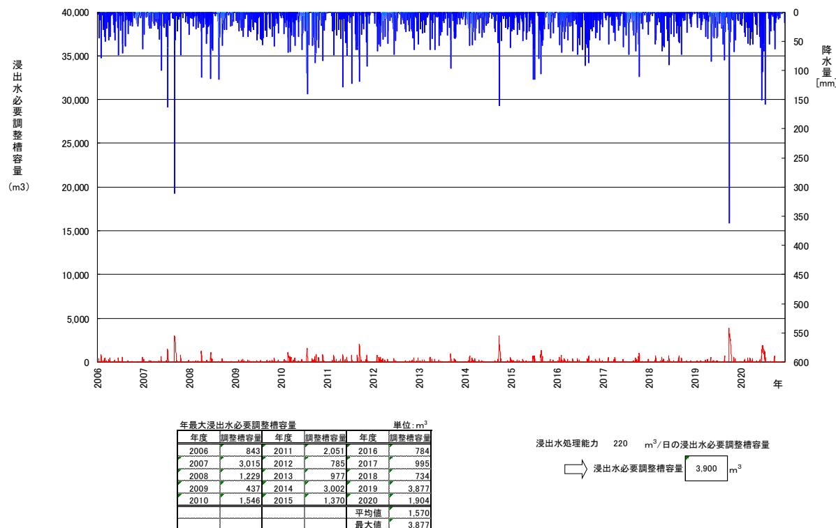
図 3-85 浸出水処理能力 220m<sup>3</sup>/日時の浸出水必要調整槽容量
