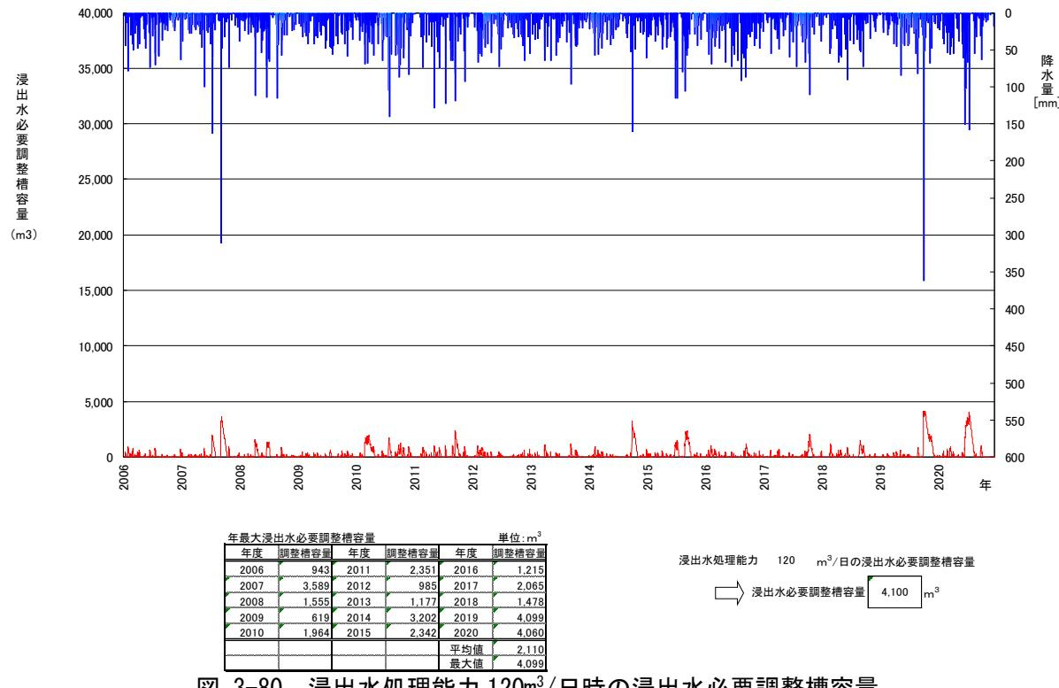
図 3-80 浸出水処理能力 120m<sup>3</sup>/日時の浸出水必要調整槽容量
