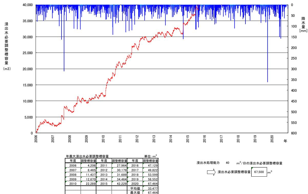
図 3-76 浸出水処理能力 40m<sup>3</sup>/日時の浸出水必要調整槽容量
