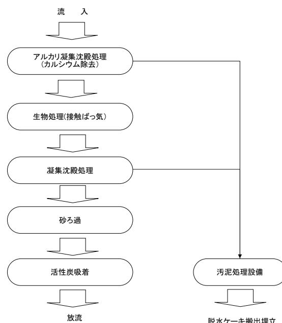
図 3-95 浸出水処理施設の処理フロー（案）
