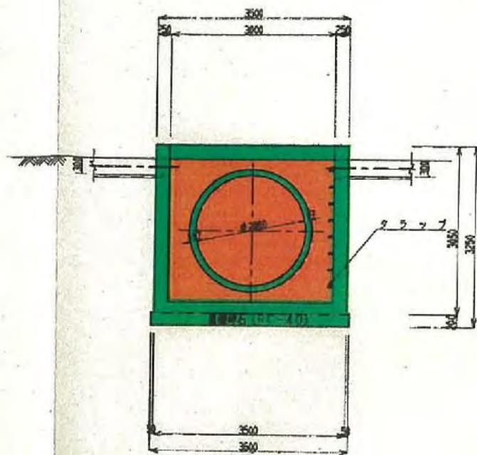
図 3-51 流入部②（既設放流枠）の構造図及び現地写真
