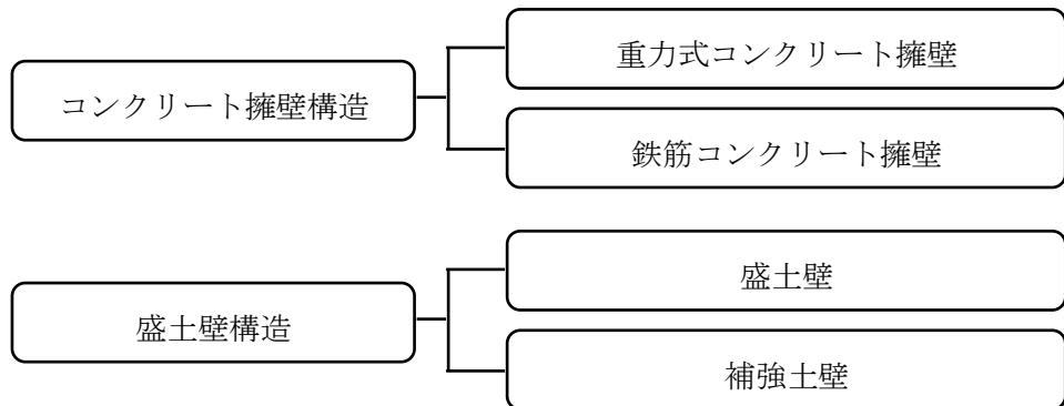
図 3-63 貯留構造物の構造形式
