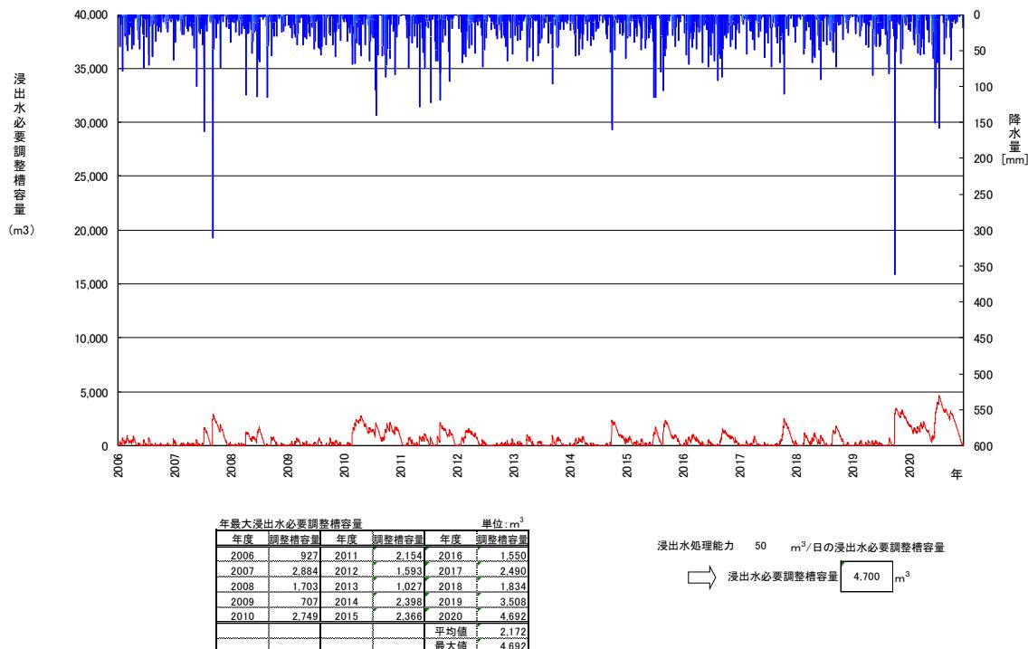
図 3-64 浸出水処理能力及び浸出水必要調整槽容量の算定結果（案 1）
