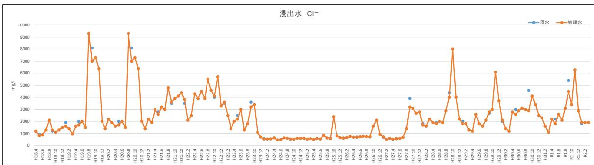
図 3-94 既設最終処分場における浸出水の原水・処理水水質 (Cl<sup>-</sup>)
