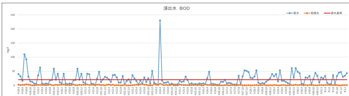
図 3-90 既設最終処分場における浸出水の原水・処理水水質 (BOD)
