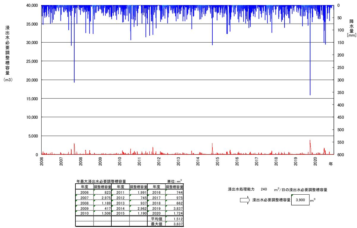
図 3-86 浸出水処理能力 240m<sup>3</sup>/日時の浸出水必要調整槽容量
