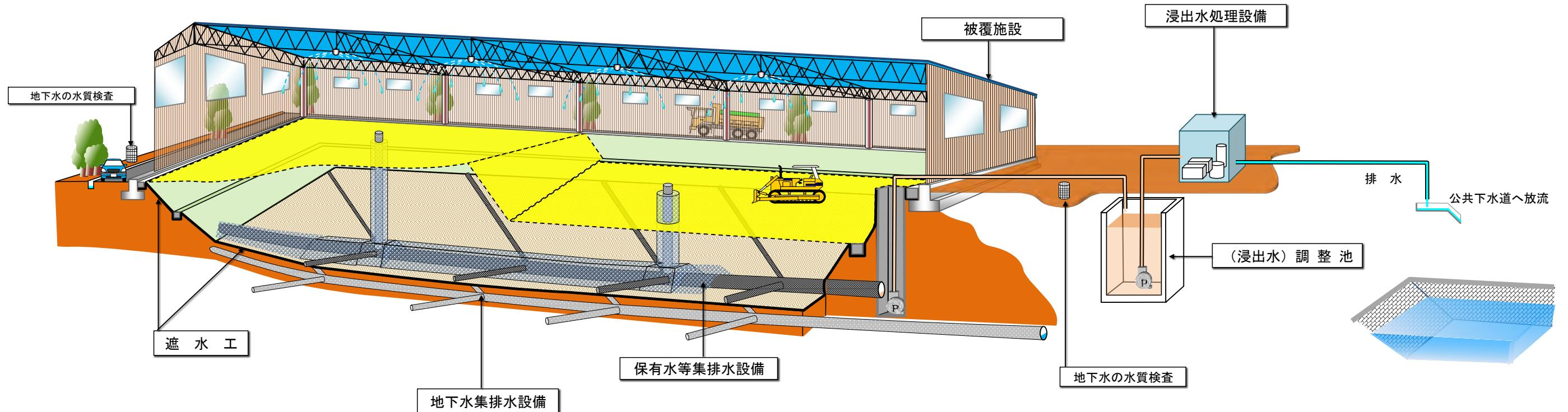
図 3-1 オープン型処分場と被覆型処分場のイメージ図
