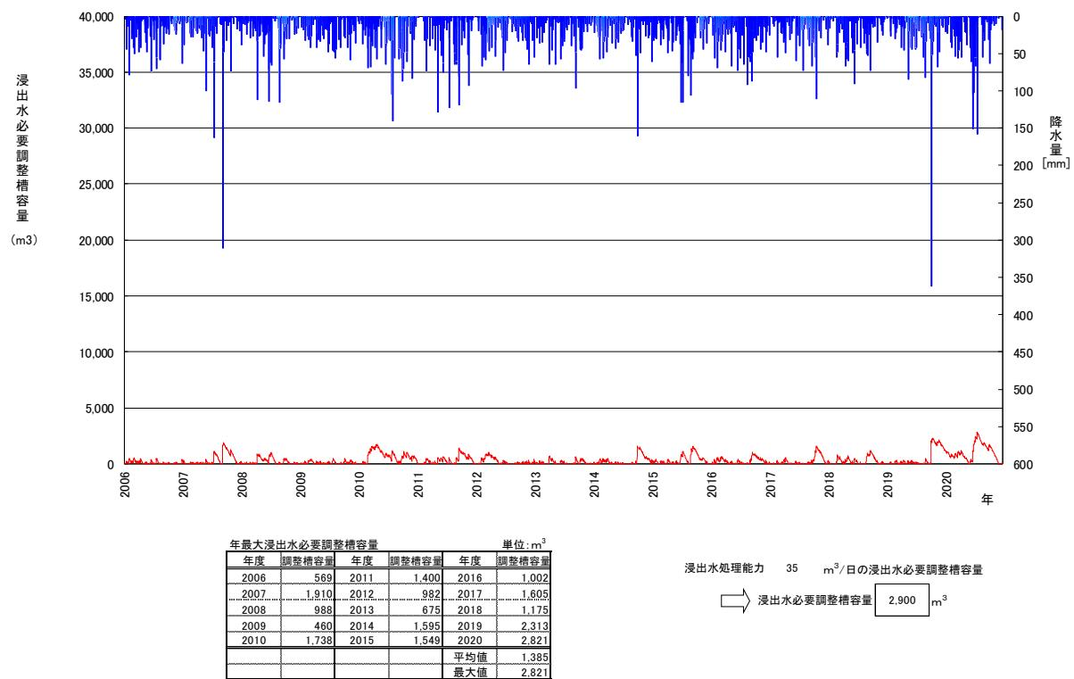
図 3-66 浸出水処理能力及び浸出水必要調整槽容量の算定結果（案 3）
