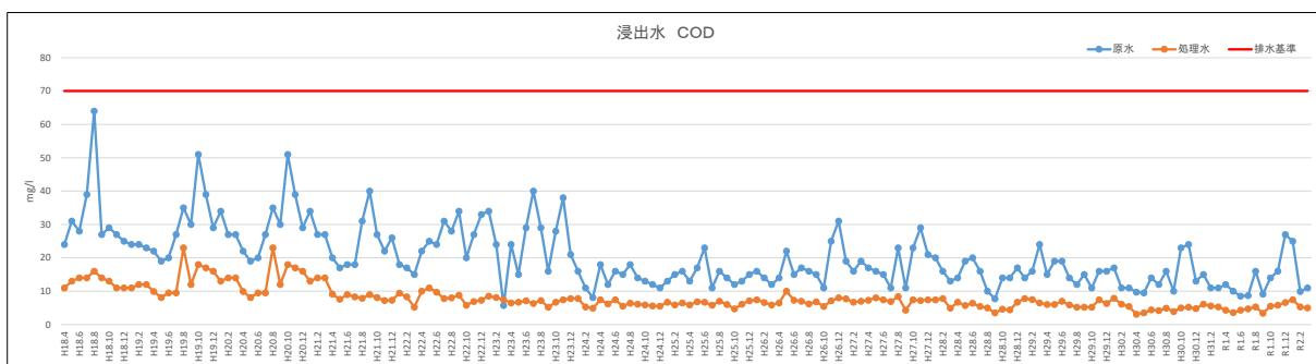
図 3-91 既設最終処分場における浸出水の原水・処理水水質 (COD)
