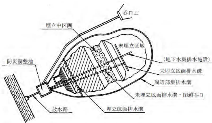
図 3-70 雨水集排水施設の概念図
