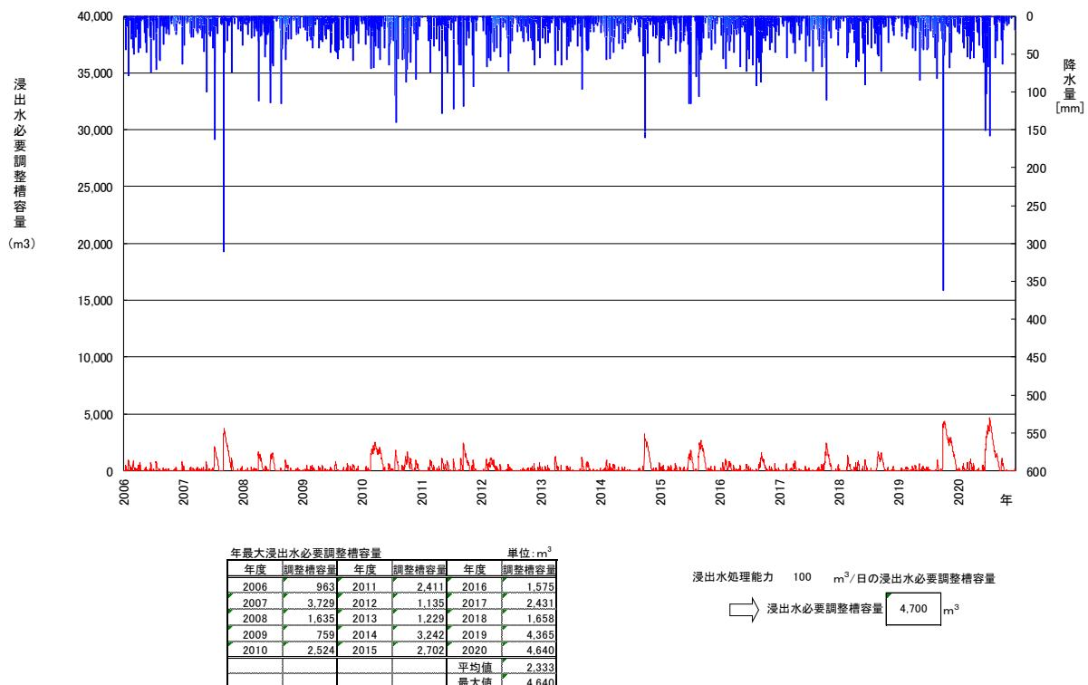
図 3-79 浸出水処理能力 100m<sup>3</sup>/日時の浸出水必要調整槽容量
