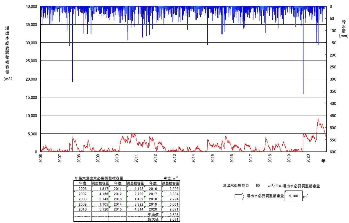
図 3-77 浸出水処理能力 60m<sup>3</sup>/日時の浸出水必要調整槽容量
