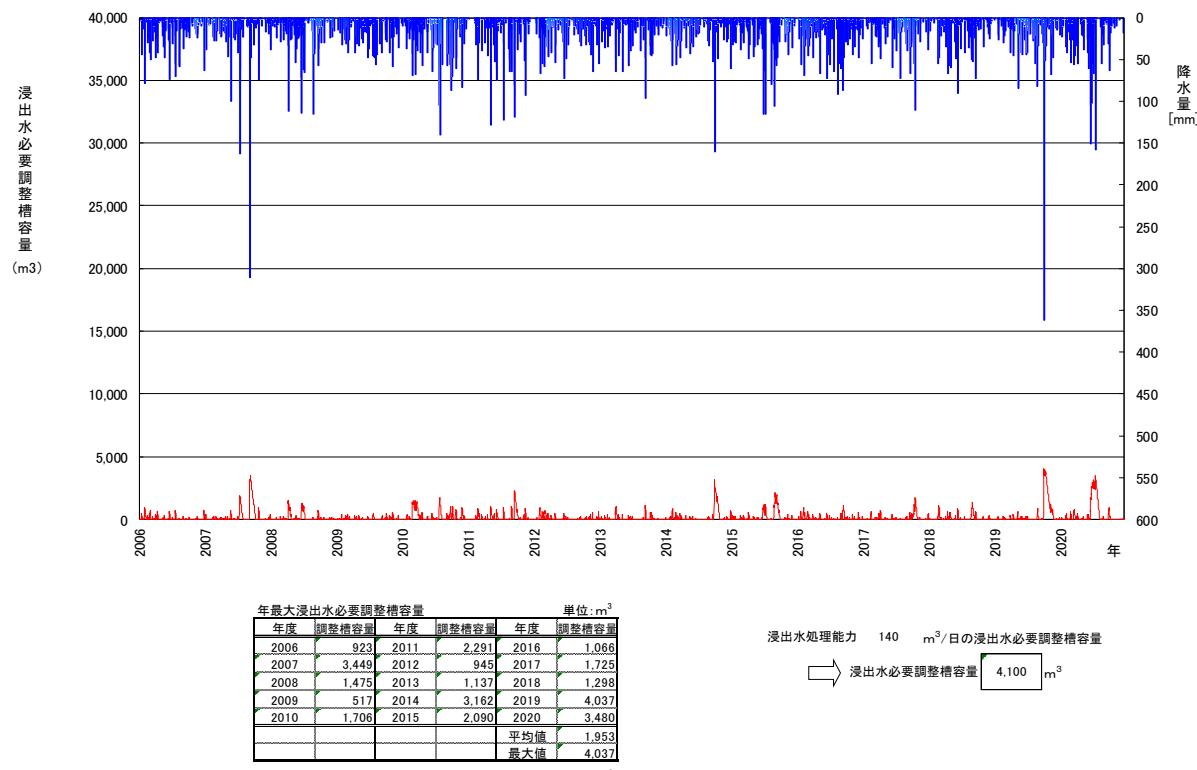
図 3-81 浸出水処理能力 140m<sup>3</sup>/日時の浸出水必要調整槽容量
