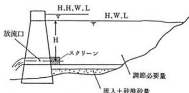
図 3-98 林地開発基準における防災調整池の概要図
