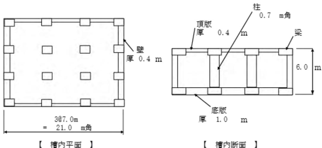
図 3-87 浸出水調整槽の1ブロックあたりの形状
