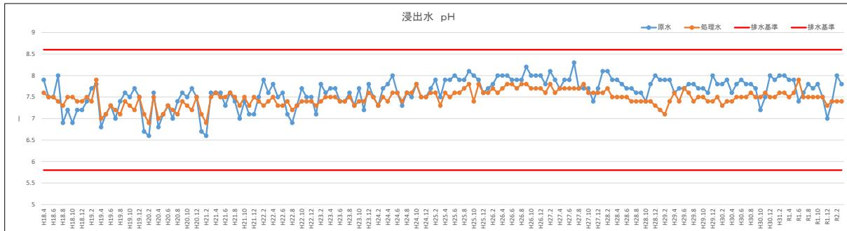
図 3-89 既設最終処分場における浸出水の原水・処理水水質 (pH)
