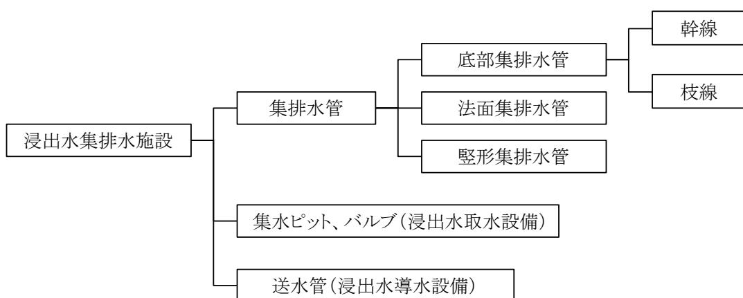
図 3-73 浸出水集排水施設の構成
