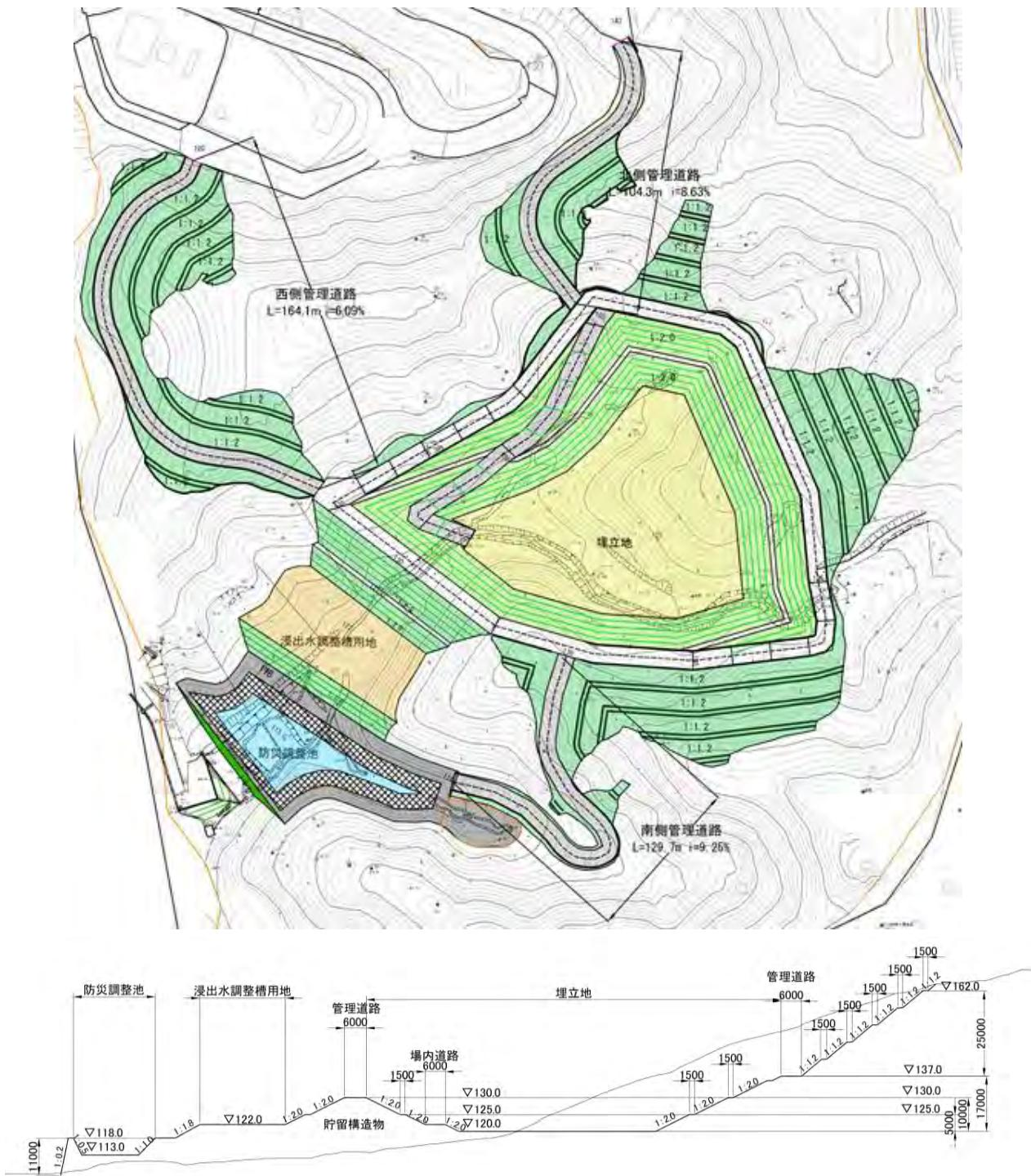
図 3-39 基本計画（案1）平面図（上）、標準断面図（下）
