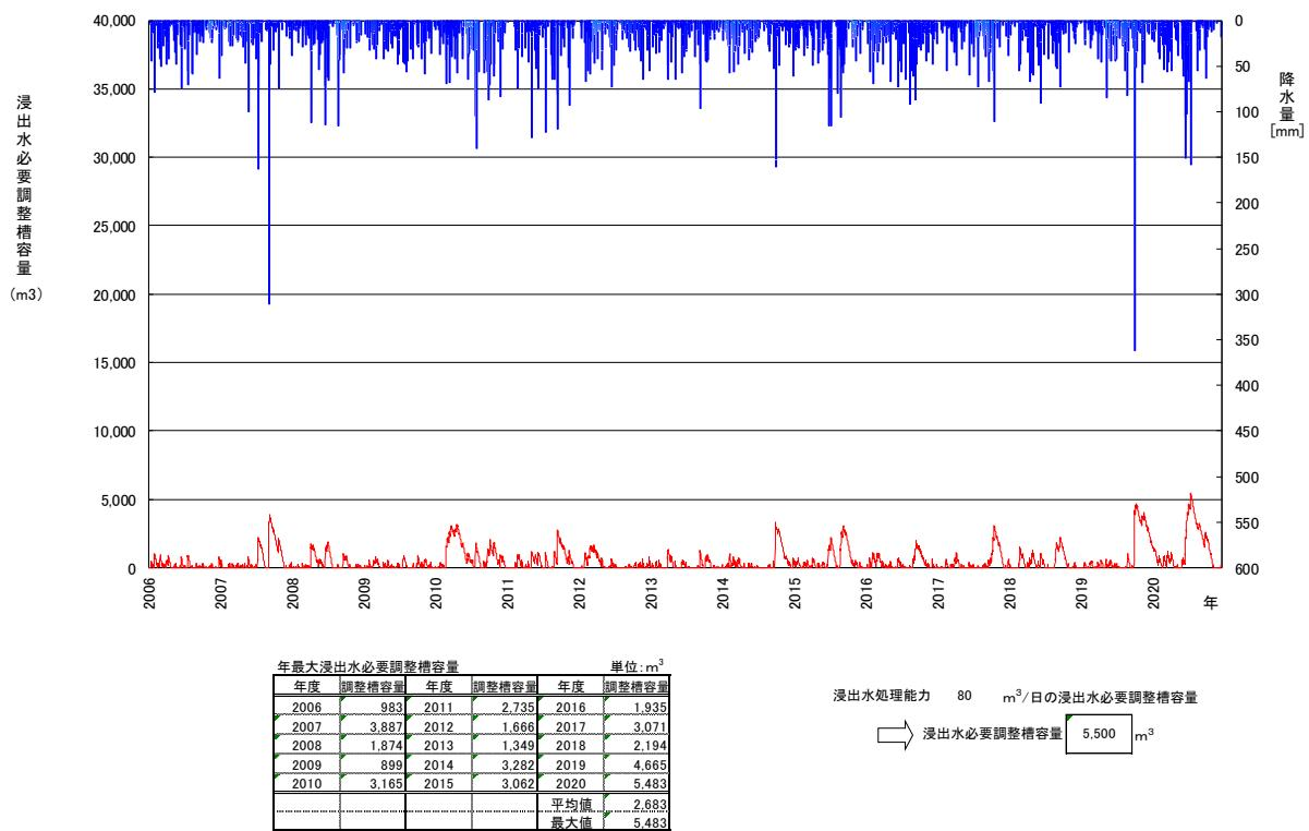
図 3-78 浸出水処理能力 80m<sup>3</sup>/日時の浸出水必要調整槽容量
