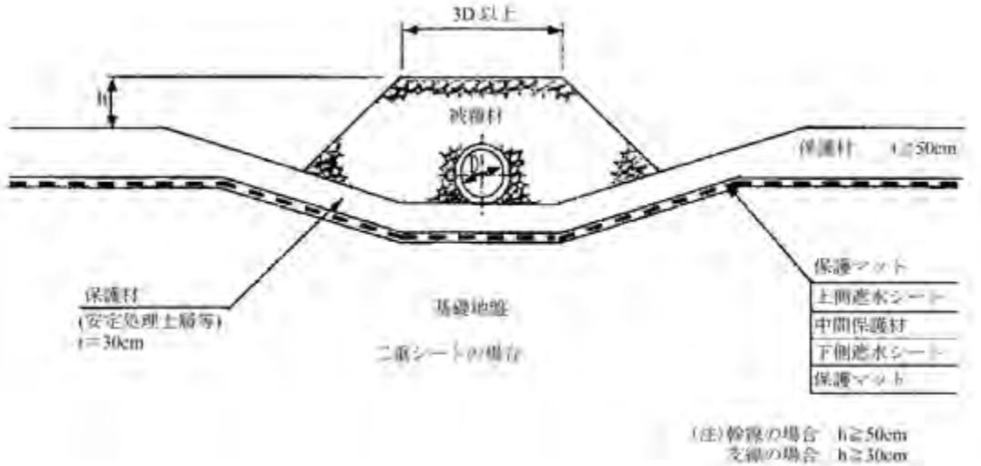
図 3-74 底部集排水管の構造例
