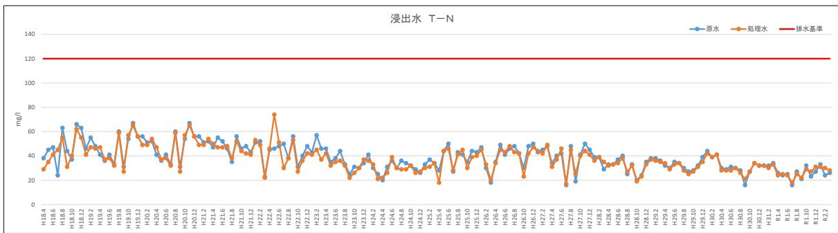
図 3-93 既設最終処分場における浸出水の原水・処理水水質 (T-N)
