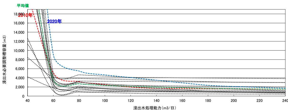
図 3-75 各年における浸出水処理能力と浸出水必要調整槽容量の関係
