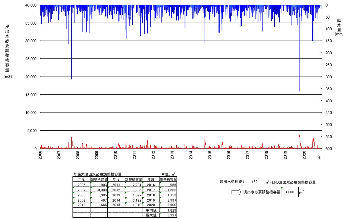
図 3-82 浸出水処理能力 160m<sup>3</sup>/日時の浸出水必要調整槽容量
