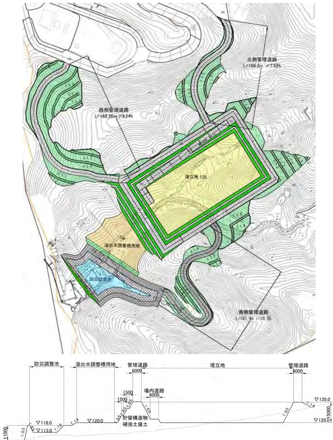
図 3-41 基本計画（案3）平面図（上）、標準断面図（下）
