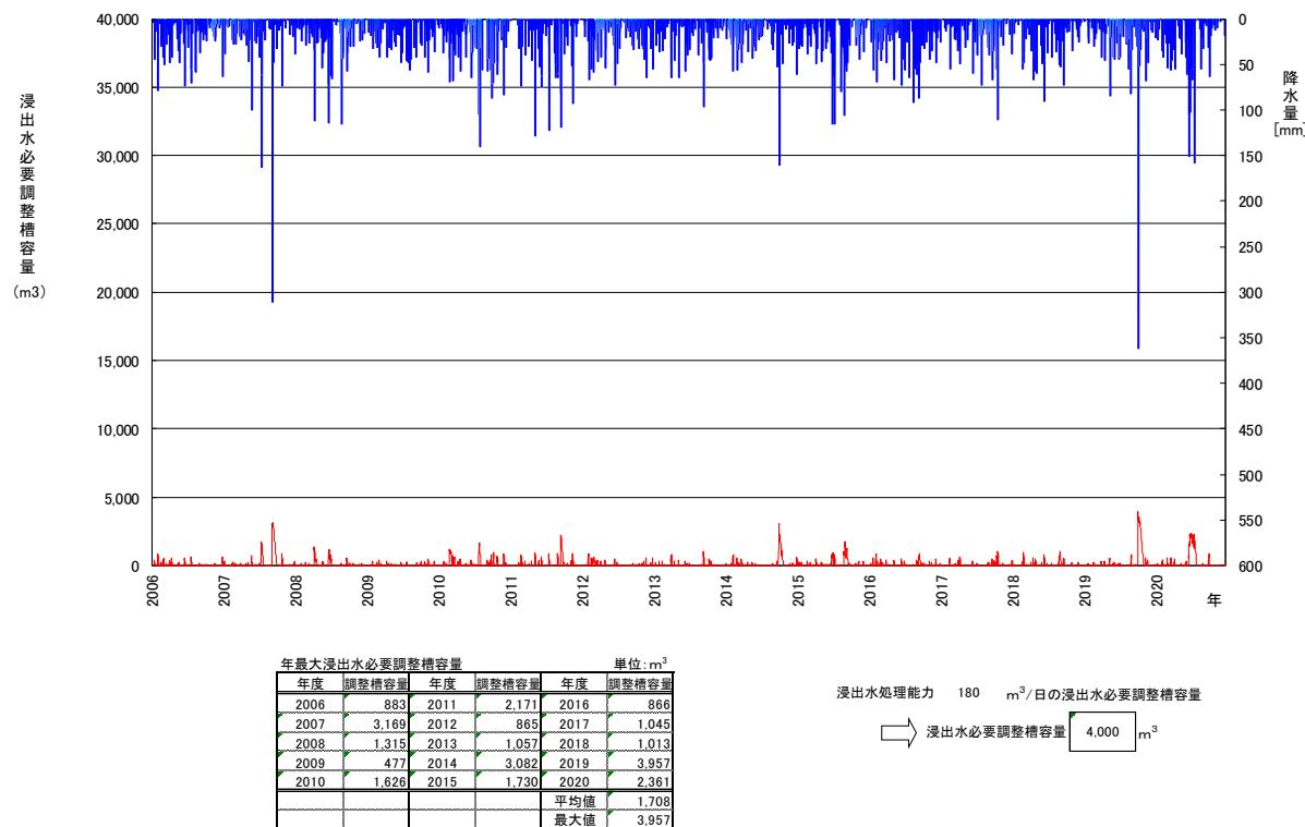
図 3-83 浸出水処理能力 180m<sup>3</sup>/日時の浸出水必要調整槽容量
