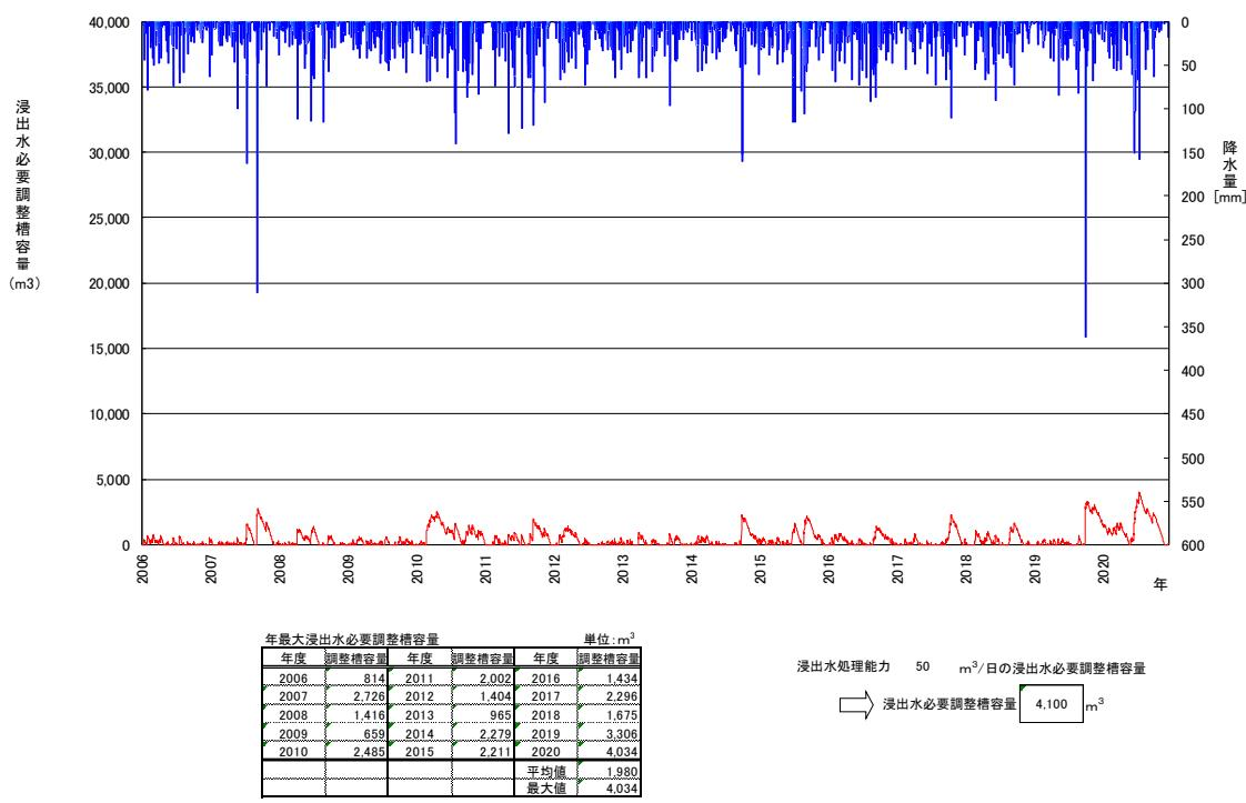
図 3-65 浸出水処理能力及び浸出水必要調整槽容量の算定結果（案 2）
