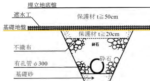
図 3-59 地下水集排水施設概念図
