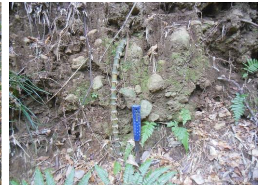
⑮ 凝灰質礫岩の露頭 風化により固結度低下、礫は容易に外れる。
